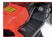
Hydrostatická automatická převodovka jednoduše ovladatelná pomocí pedálu
