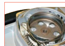
Brzdová páska pro zastavení nožů.
