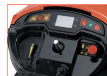
Elektromagnetická spojka žacího ústrojí s pohodlným nastavením výšky sekání.
