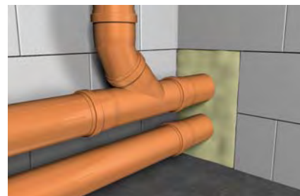
Vyplňování prostupů potrubních systémů
