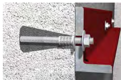
Detail: Otvor v pórobetonu
